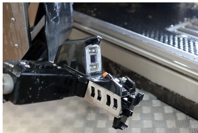
Braccio multifunzione del robot dotato di un sensore O3D di ifm electronic
