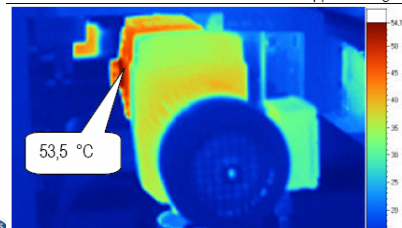
FARDELLATRICE: motoriduttore rotazione tappeto di ingresso
