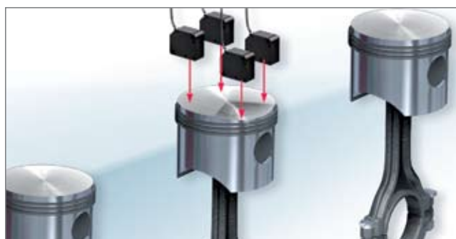
▲ Controllo della planarità del cielo dei pistoni
