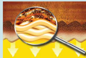
I prodotti di degradazione dell'olio si depositano sulle fibre di cellulosa.
