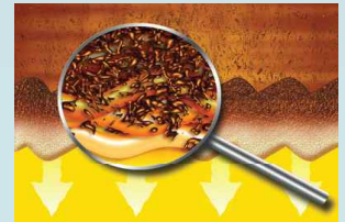
La cartuccia di filtrazione fine pulisce l'olio fino a completa saturazione delle fibre.
