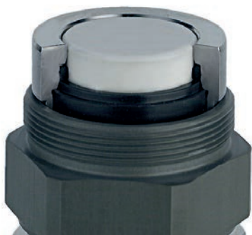
Cella di misura in ceramica installata in un attacco di processo M44x1,25. La guarnizione è incassata e quindi protetta.
