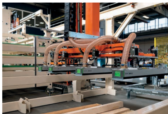
Manipolatore con 4 gripper di Piab, che consentono di movimentare uno strato di listelli di legno grezzo
