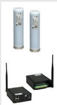
In prospettiva della manutenzione predittiva, il sistema GradeSens, composto da antenne a fissaggio magnetico e gateway, in comunicazione wireless tra di loro, consente il monitoraggio di vibrazioni durante il ciclo operativo. Il sistema misura la temperatura e le vibrazioni su 3 assi, garantendo un'eccellente sensibilità e precisione anche
