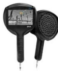
**TELEDYNE FLIR** presenta due modelli aggiuntivi della telecamera FLIR Si124 Industrial Acoustic Imaging: la Si124-LD, per il rilevamento di perdite di aria compressa, e la Si124-PD, per il rilevamento di scariche parziali all'interno di componenti elettrici di media e alta tensione. Questa espansione fornisce
