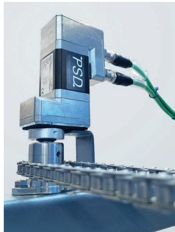
*I Direct Drives PSD regolano gli assi della macchina e possono far funzionare non solo i mandrini ma anche cinghie e catene*
