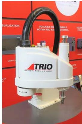
**TRIO MOTION TECHNOLOGY** annuncia la produzione di una linea di robot accessibile anche per utenti con una limitata esperienza di robotica. Adatta alle aziende di produzione elettronica, imballaggio e movimentazione dei materiali, la gamma comprende quattro robot SCARA che vanno da un braccio di 400 mm e una capacità di carico massima di 3 kg, fino a un braccio di 700 mm e una capacità di carico massima di 6 kg. Ogni robot è
