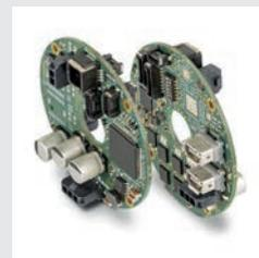
Questi Epos sono particolarmente adatti per le applicazioni nella robotica (ad esempio per l'integrazione in elementi articolati) ma anche per gli azionamenti nelle ruote. I nuovi controllori sono disponibili nelle dimensioni 60 o 90mm, sia in versione CANopen che in versione EtherCAT.
