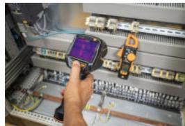
**TESTO** presenta la termocamera Testo 883, caratterizzata da un'alta risoluzione: 320 x 240 pixel (espandibile a 640 x 480 pixel con tecnologia Testo SuperResolution integrata) e messa a fuoco manuale.
