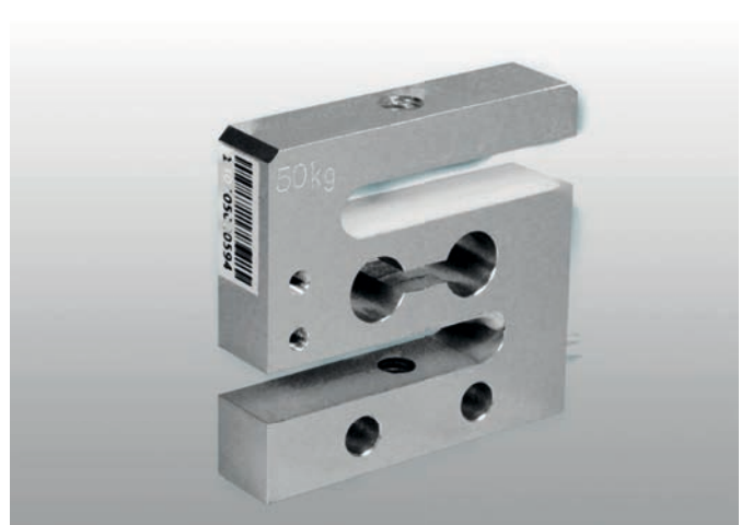
Cella di carico di tipo "S" in lega d'alluminio per applicazioni in trazione o compressione, particolarmente adatta per pesature di piccoli pesi in sospensione come sacchi di liquidi per il settore medicale o prova di resistenza di trazione per tubi in plastica
