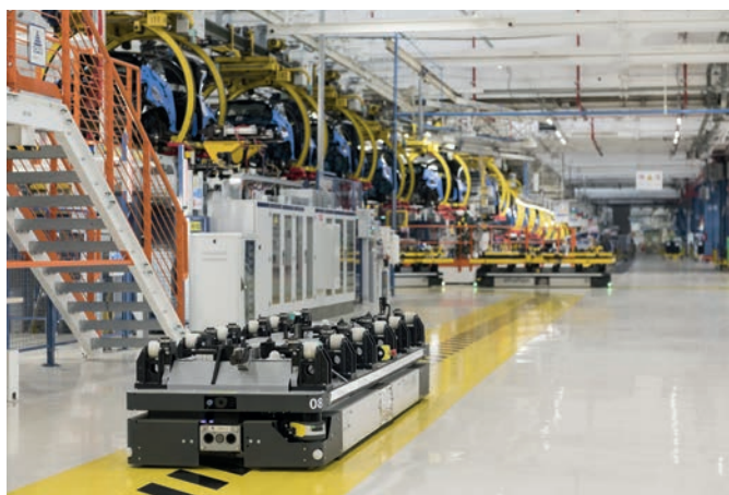
CPM e SEW-EURODRIVE hanno lavorato insieme alla progettazione e allo sviluppo degli AGV a induzione ProFleet, realizzando una tecnologia estremamente innovativa
